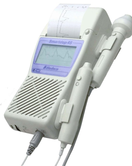
Possibilità di utilizzare due sonde contemporaneamente e di passare da una all'altra semplicemente premendo sul tasto del manipolo amplificatore
